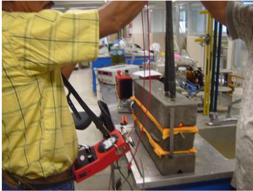
Figura 4.9 Muestra los bloques de concreto y posición de electrodos en uno de los extremos para identificar daño por corrosión
