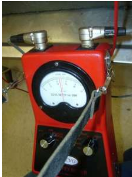
Figura 4.10 Muestra la caratula analógica del equipo que indica la zona anódica y catódica
