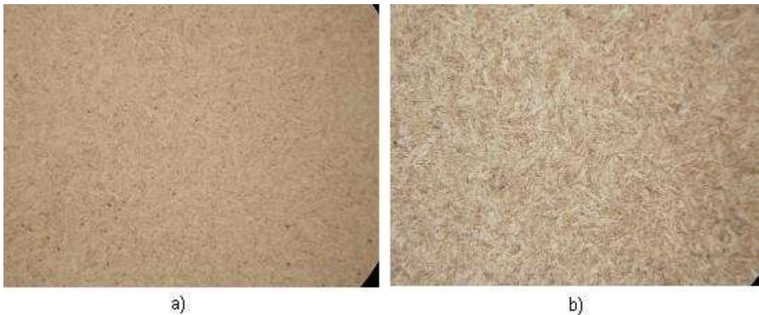
Figura 5.2 a) Atacado 13 seg. Sección transversal 100x, b) La misma atacada 16 seg. 100x.
