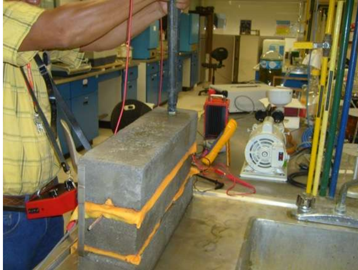
Figura 4.11 Muestra la posición de los electrodos en el extremo para detectar el posible daño causado por corrosión
