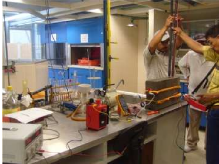
Figura 4.8a Muestra los bloques de concreto, el sistema de protección catódica y el equipo de DCVG
