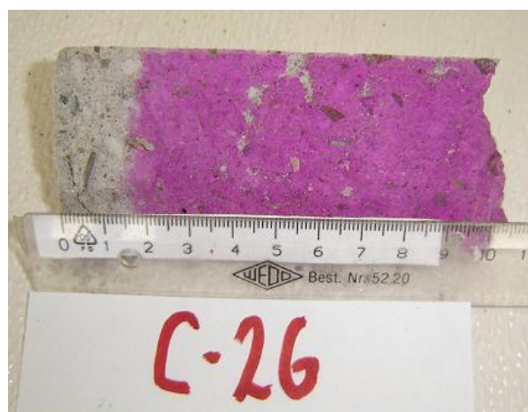
Figura 3.4 Frentes de Carbonatación de los cilindros extraídos
