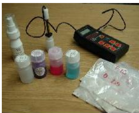
Figura 3.5 Extracción de muestras para cloruros y equipo empleado
