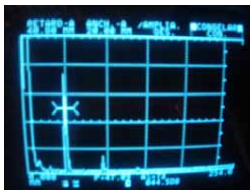
b) Reflexiones de pared posterior para tamaño de grano ASTM 2
