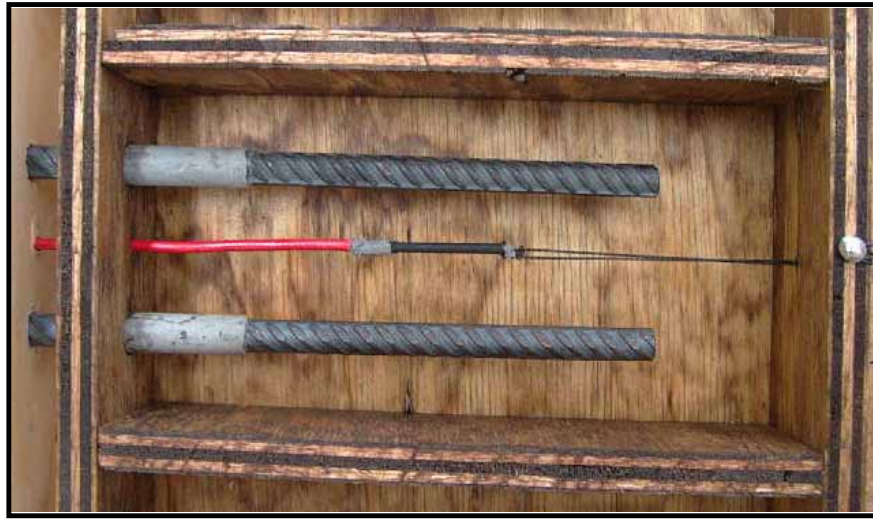
Figura 3.9 Imagen a detalle de un molde individual con sus elementos ubicados en su posición final
