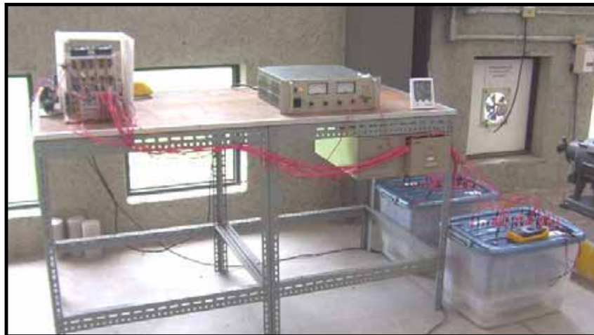
Figura 3.24 Aplicación de las corrientes de protección aceleradas
