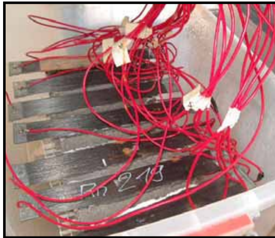
Figura 3.20 Conexiones eléctricas en las cámaras de humedad controlada
