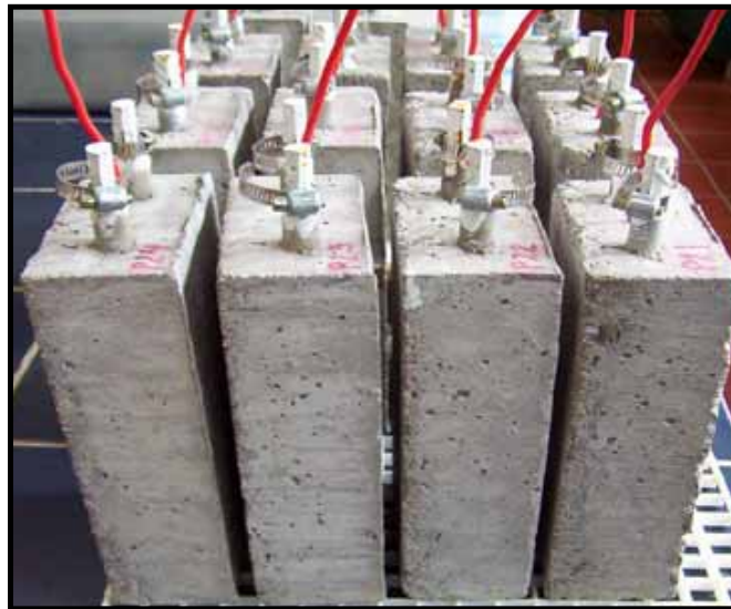
Figura 3.14 Prismas de concreto estudiados en ambiente de laboratorio
