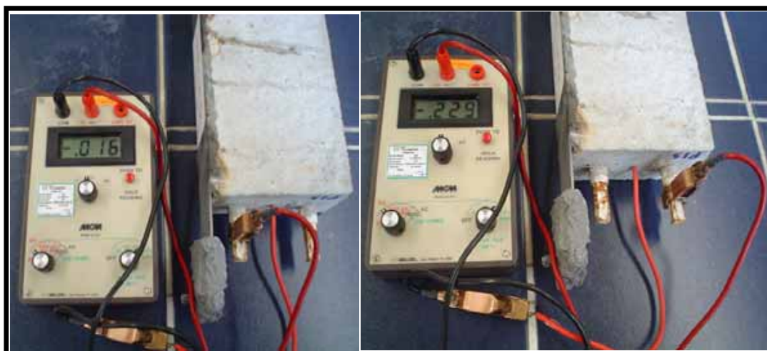
Figura 3.26 Medición del potencial de media celda para las barras de refuerzo
