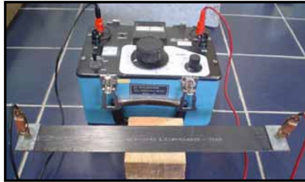
Figura 3.31 Medición de la resistencia eléctrica del CFRP antes de su colocación utilizando el resistómetro Nilsson
