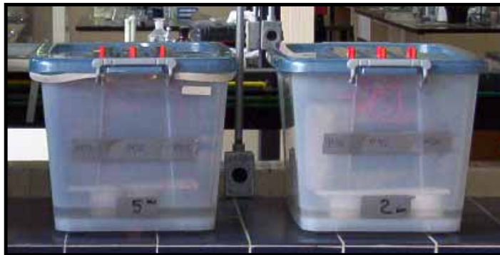
Figura 3.19. Imagen de las cámaras de humedad relativa controlada
