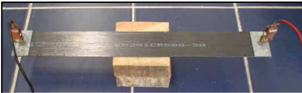
Figura 3.30 Medición de la resistencia eléctrica del CFRP antes de su colocación
