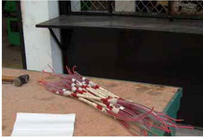
Figura 3.14 Varillas con mangueras plásticas en sus extremos
