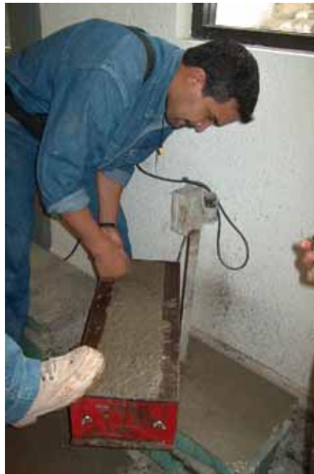
Figura 3.23 Vibración de los especímenes sobre una mesa vibratoria
