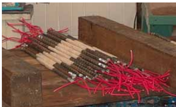
Figura 3.9 Unión del cable y varilla con un epoxico
