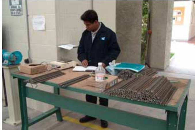
Figura 3.5 Tramos 45.00 cm. de varillas de acero
