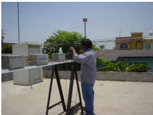
Figura 3.37 Preparación del espécimen para la realización de las mediciones electroquímicas
