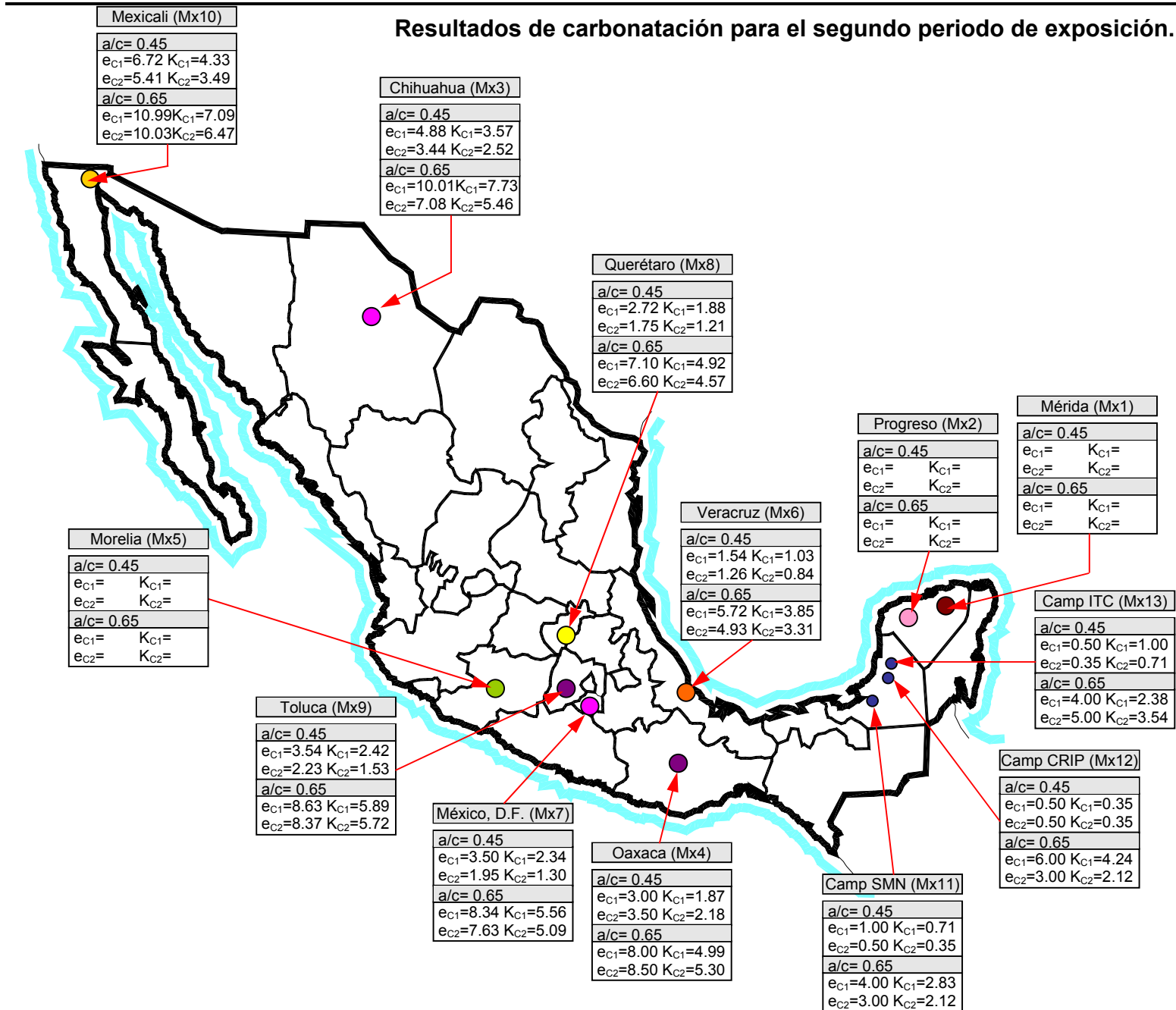
Figura 5.13 Resultados de carbonatación para el 2º periodo de exposición
