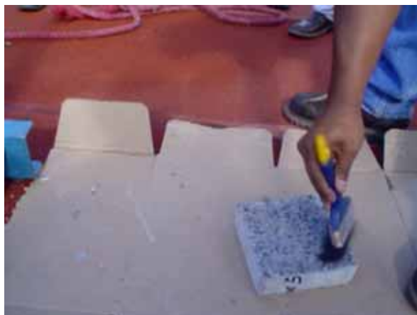
Figura 3.43 Limpieza de la superficie de la probeta
