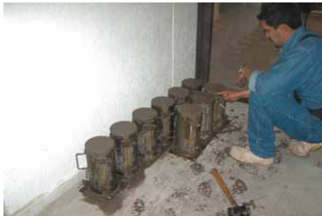
Figura 3.26 Elaboración de especímenes para la prueba de resistencia a la compresión
