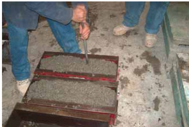
Figura 3.18 Buena trabajabilidad de la mezcla, y elevada cohesión
