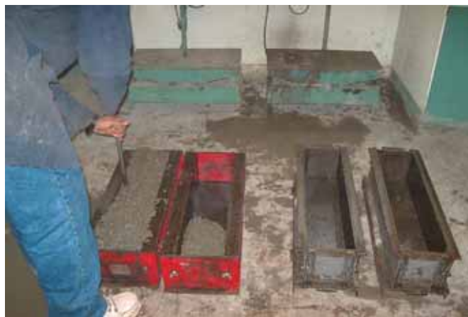
Figura 3.2 Fabricación de especímenes de concreto sin acero de refuerzo
