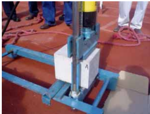
Figura 3.42 Corte del espécimen de concreto
