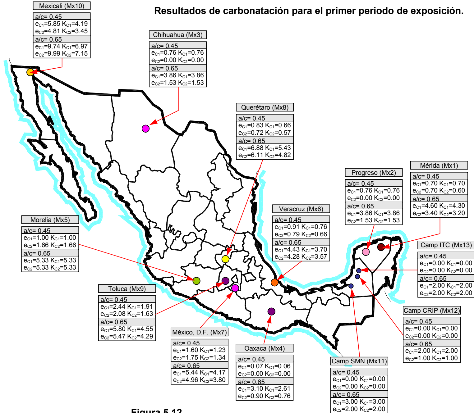
Figura 5.12 Resultados de carbonatación para el 1 er periodo de exposición
