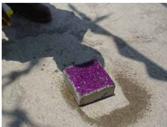
Figura 3.44 Rociado de la cara recién cortada con fenolftaleína
