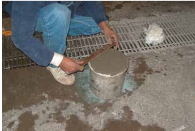
Figura 3.21 Prueba de peso volumétrico de la mezcla
