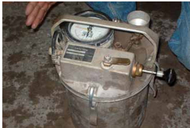
Figura 3.22 Determinación del contenido de aire
