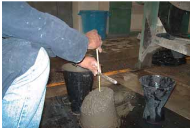
Figura 3.20 Realización de la prueba de revenimiento
