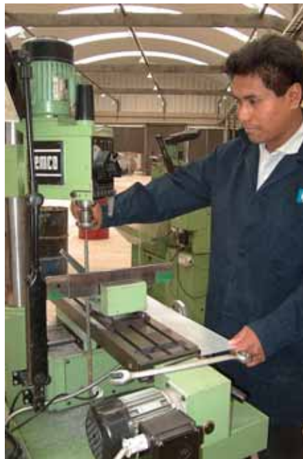
Figura 3.6 Perforación de un extremo de la varilla
