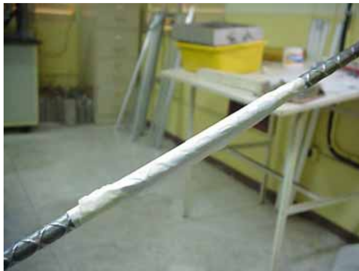
Figura 3.11 Protección de la parte central de las varillas
