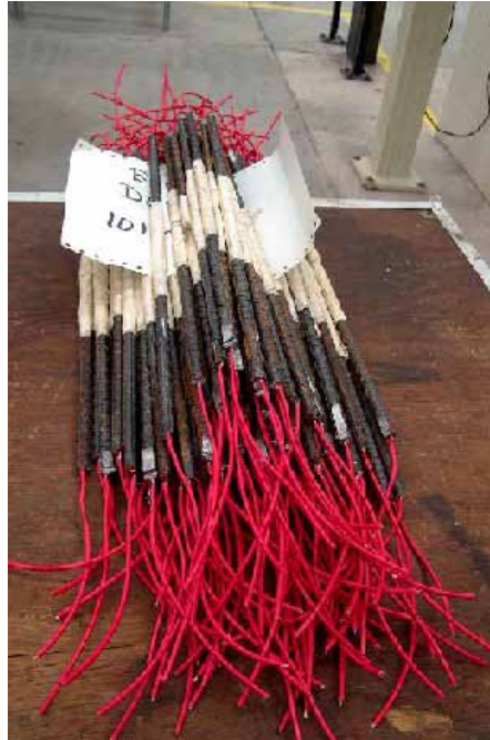
Figura 3.12 Protección de la parte central de las varillas
