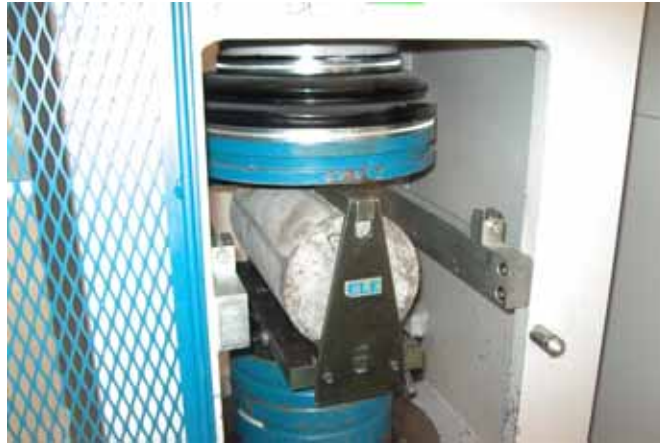
Figura 3.27 Especímen sometido a la prueba de tensión indirecta
