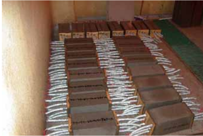
Figura 3.25 Especímenes colocados en un cuarto húmedo durante 28 días
