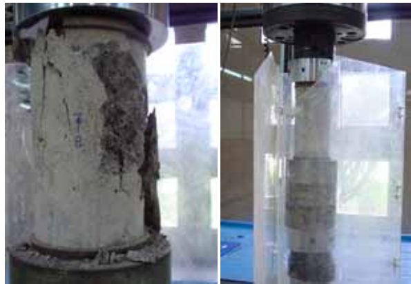
Figura 14 Ensayo de resistencia a compresión
