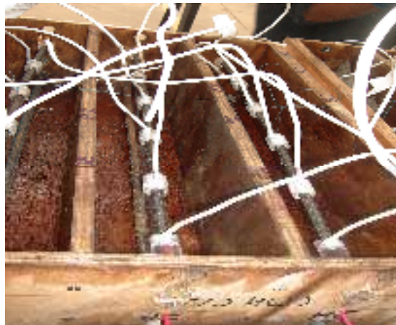
Figura 9 Diseño de los moldes para las probetas
