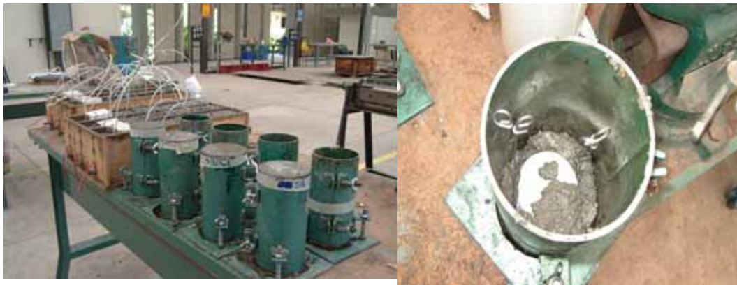
Figura 7 Probetas durante el proceso de colado
