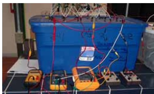
Figura 13 Prueba de decaimiento de depolarización
