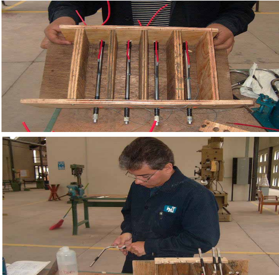
Figura 3.1 Fabricación de moldes y habilitado del acero inoxidable
