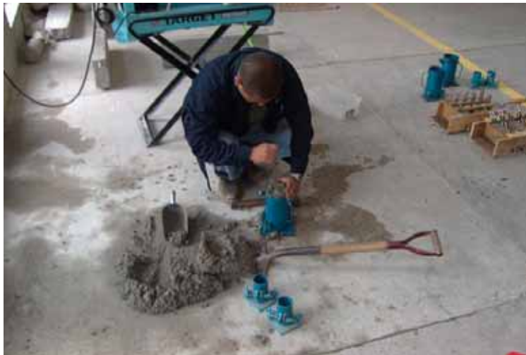
Figura 3.6 Proceso de mezclado para la fabricación de prismas y cilindros.
