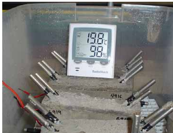
Figura 3.9 Cámara de humedad controlada sin tapa para que se observe el interior
