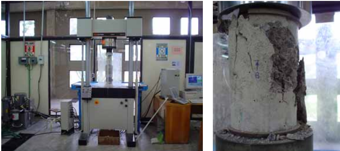
Figura 3.10 Equipo para la prueba de resistencia a la compresión y cilindro después del ensayo
