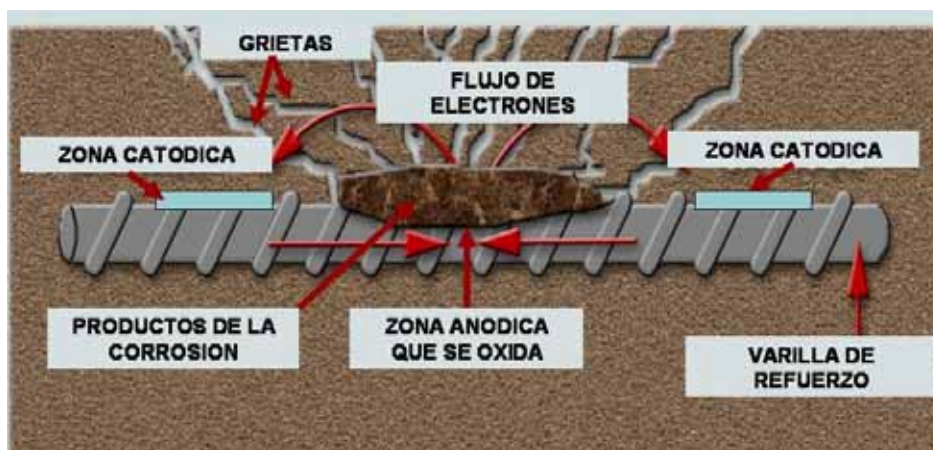
Figura 1.2 Representación esquemática del proceso electroquímico de corrosión de las armaduras en el concreto
