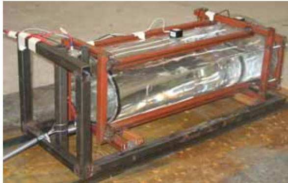
Figura 3.9 Instrumentación del conjunto tonel con base metálica.
