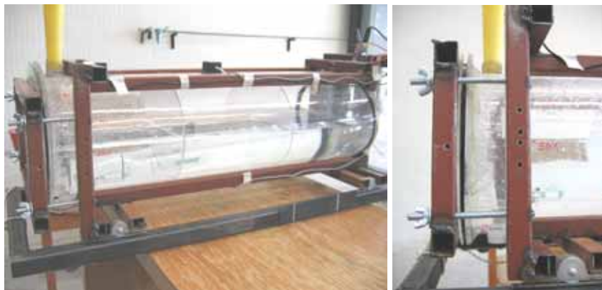
Figura 3.3 Verificación de los niveles reales de llenado del tanque a escala.
