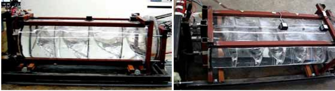
Figura 3.13 Ejecución de las pruebas de oleaje con el tanque a escala.
