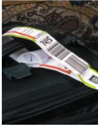
Figura 16 Etiqueta para equipaje con código de barras, e identificación por radiofrecuencia
