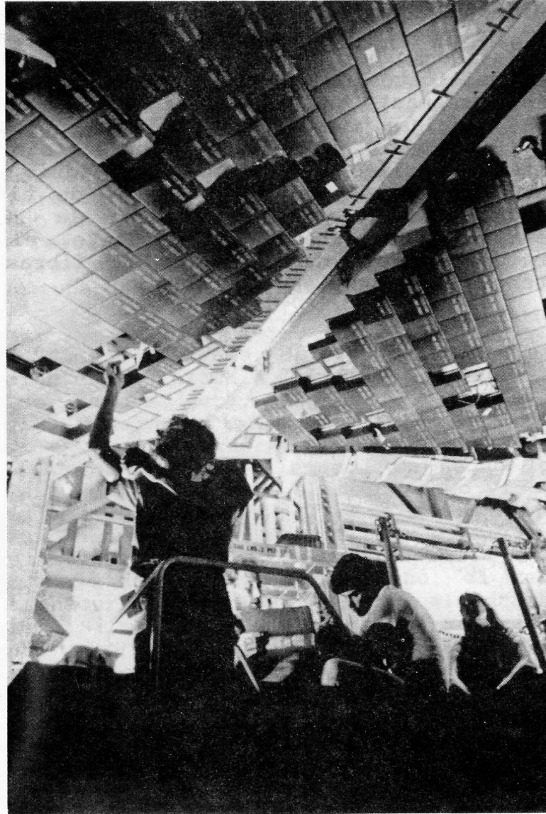
RECUBRIMIENTO CERAMICO EMPLEADO PARA PROTEGER LA ESTRUCTURA DE UN VEHICULO AEROSPAIAL, EN EL REINGRESO A LA ATMOSFERA.
