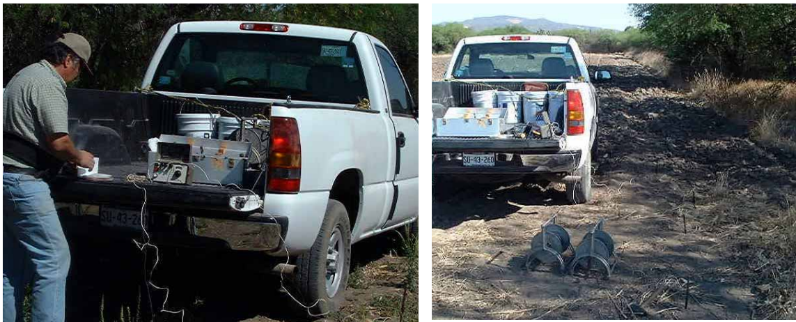
Fig 2.22. Resistímetro, cables electrodos y tendidos
