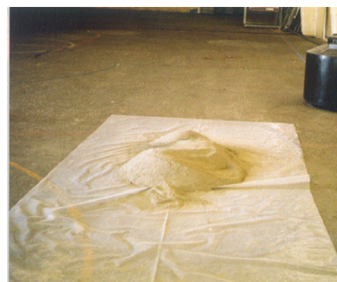
Fig 1.4. a) Lavado, secado de la muestra, tamizado y selección del sedimento
