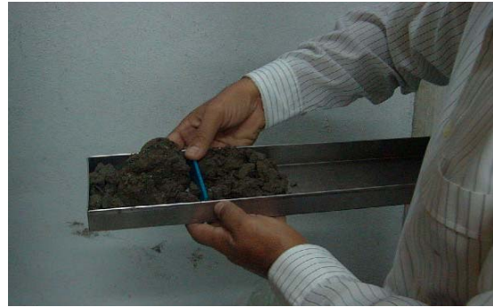
Foto A3.3. Colocación de la arena en la charola
