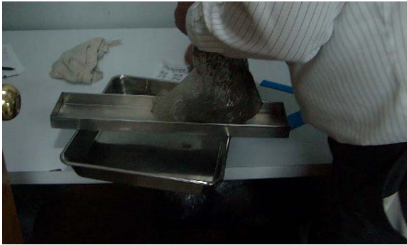
Foto A3.2. Vaciado de la muestra en la charola
