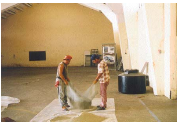
Fig 1.4. a) Lavado, secado de la muestra, tamizado y selección del sedimento
