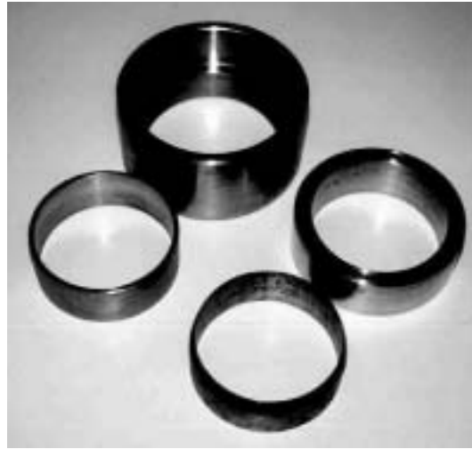
Figura A.3 Anillos de acero inoxidable para labrar probetas en los ensayos edométricos, obtenidas de una probeta compactada en condiciones isótropas.
