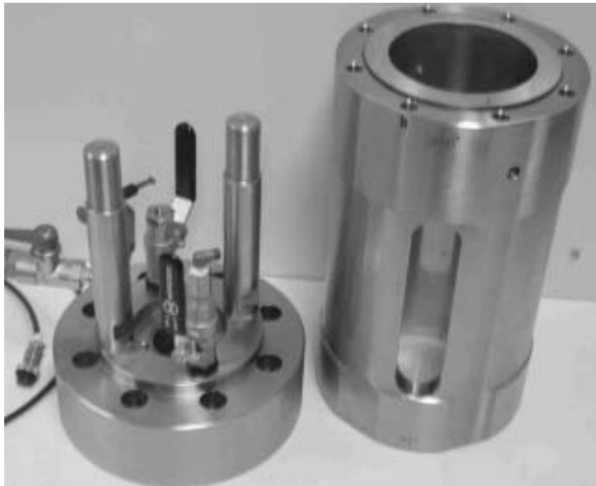
Figura 3.24 Cámara y tapa de la célula triaxial, con control de succión.
