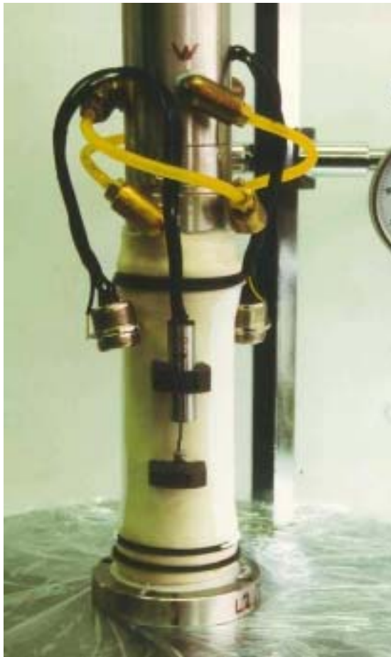
Figura C.4 Conexiones de los sistemas de presión ( u_a , u_w ), montaje de los LVDTs y colocación de las membranas sobre la muestra.
