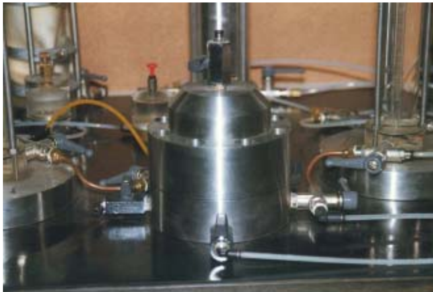
Figura B.4 Mini-célula isotrópica rígida con los medidores de volumen.
