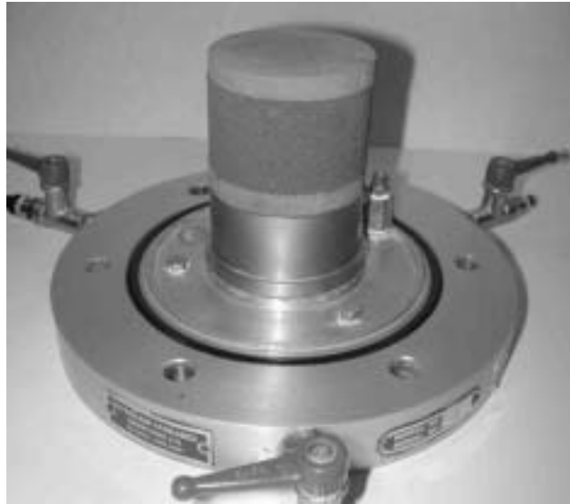
Figura A.1 Probeta ( \lambda\# 70 mm, h = 40 mm), antes de la compactación isotrópica.
