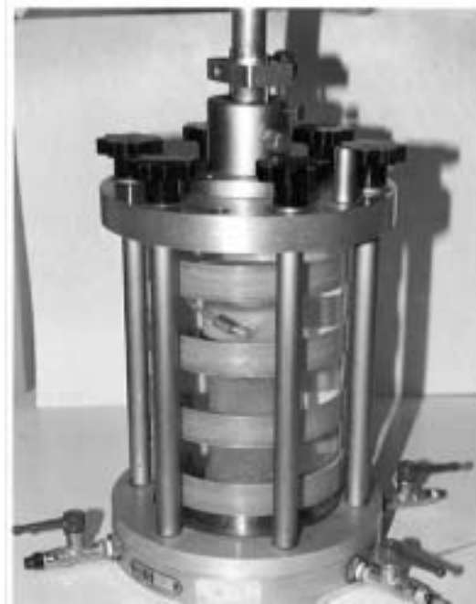
Figura C.1 Compactación estática en condiciones isotrópica (tensión controlada), cámara triaxial convencional ( \lambda_0=50 mm, h_0=100 mm).
