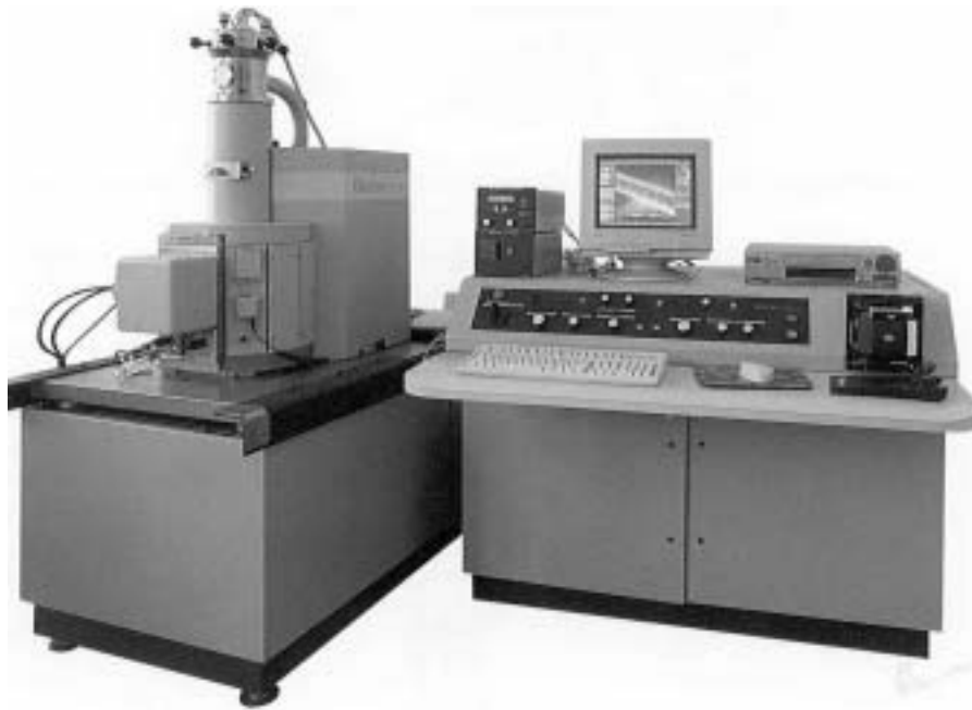
Figura 4.3 Microscopio electrónico de barrido ambiental, Electroscan 2020 (ESEM).
