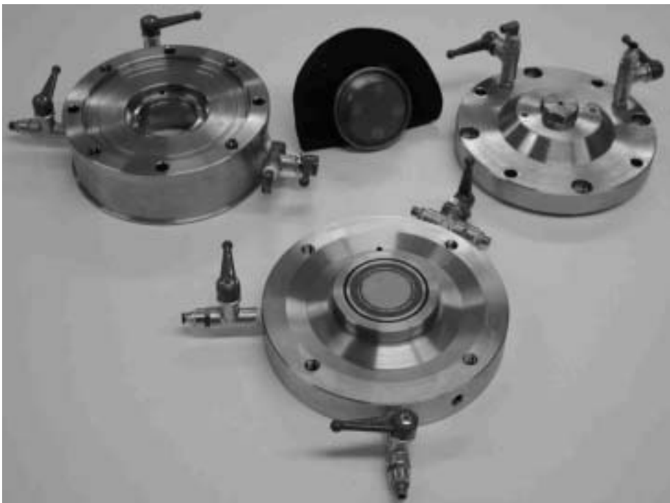
Figura 3.7 Edómetro con control de succión matricial ( u_a - u_w ), y total ( \Phi ).
