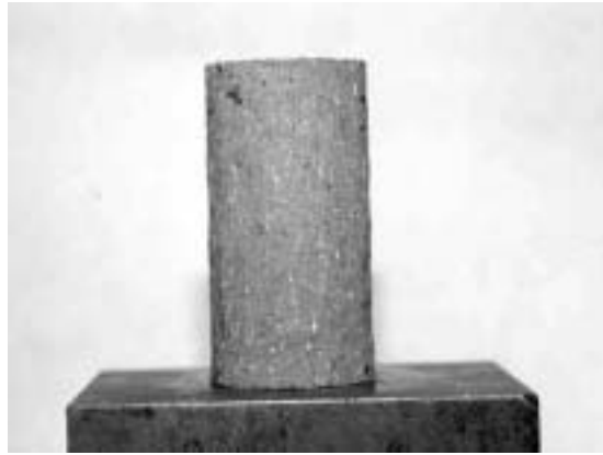
Figura C.3 Probeta de \lambda_0 = 38 mm y h_0 = 76 mm, en ensayos isótopos y triaxiales (célula triaxial con control de succión).
