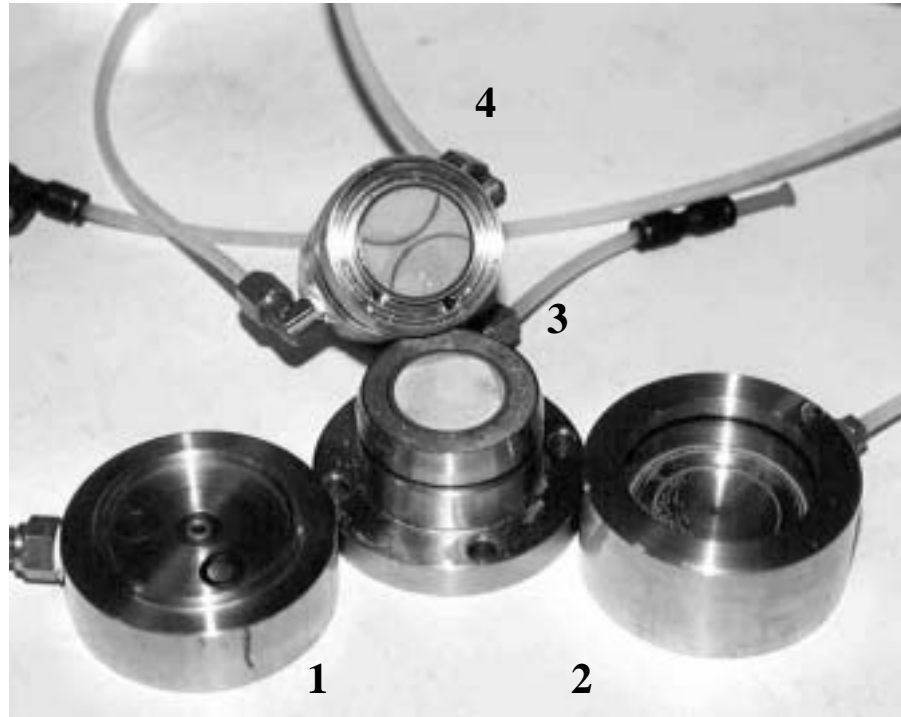
Figura 3.14a Piezas especiales para saturación y determinación de la permeabilidad (No 1 y 2) de los discos cerámicos (AVEA) del pedestal y cabezal (célula triaxial con control de succión).
