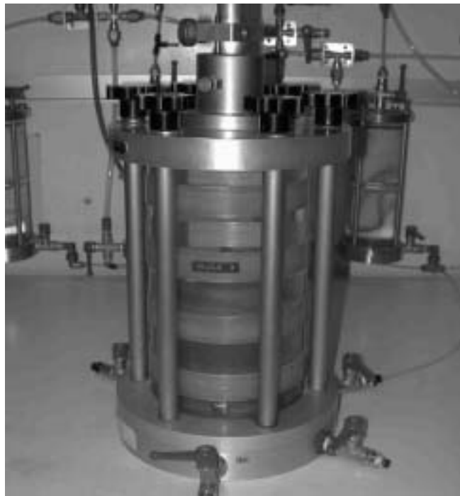
Figura A.2 Compactación estática, bajo condiciones isotrópica de una probeta ( \lambda\# 70 mm, h= 40 mm), para obtener por medio de labrado una probeta ( \lambda\# 50 mm, h = 20 mm) para un ensayo edométrico.
