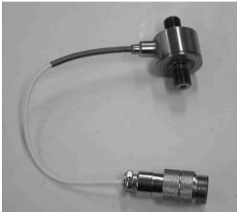
Figura 3.36 Fotografía de la célula de carga (SENSOTEC; capacidad 8.9 kN).
