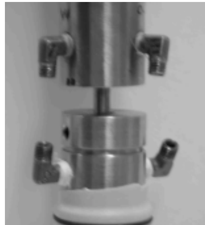
Figura 3.22 a) célula de carga roscada entre el cabezal y pistón superior; b) pieza de alineación no-contacto en la ejecución de los ensayos isótropos.
