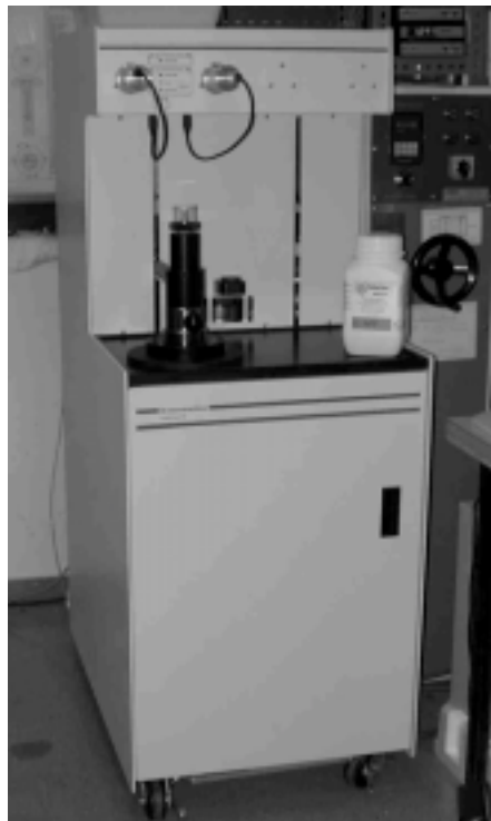
Figura 4.5 Porosímetro por intrusión de mercurio (Micromeritics).
