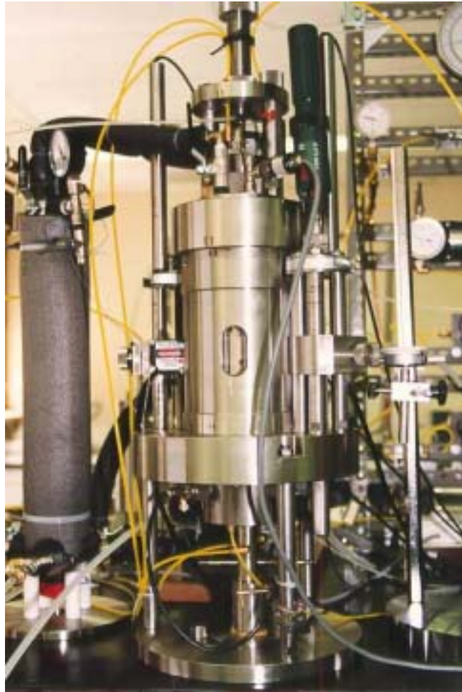
Figura 3.21b Foto de la célula triaxial con control de succión.
