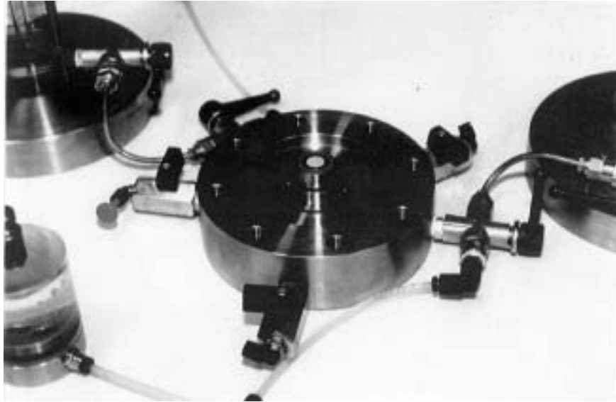
Figura B.1 Cuerpo inferior de la mini-célula isótropa rígida.
