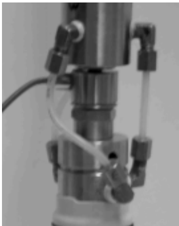
Figura 3.21b Foto de la célula triaxial con control de succión.
