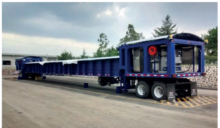
Simulador de Vehículos Pesados (HVS), equipo que aplica cargas reales del autotransporte y de aeronaves en una pista de ensayos a escala natural.
