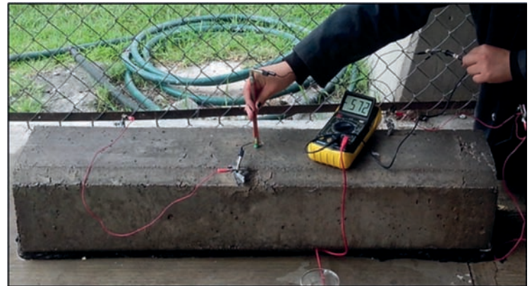
Figura 3: Medición de potencial de protección.
