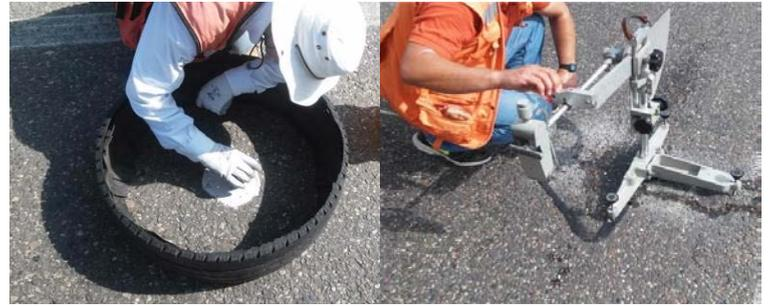
Figura 1. Método del Círculo de Arena para determinar macrotextura y mediciones de fricción con Péndulo Británico.
