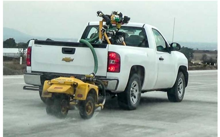
Figura 2. Mediciones de fricción con el equipo Mu-meter MK6 del IMT.
