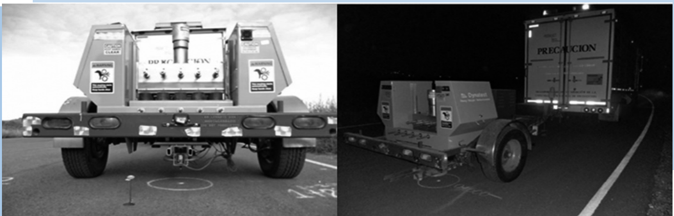
Figura 1 Determinación de deflexiones con HWD para diferentes horas del día
