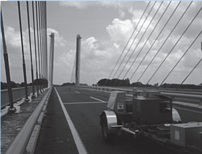
Figura 2 Prueba dinámica experimental con condiciones de tráfico controladas en el
