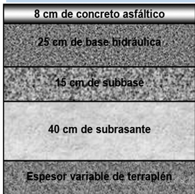
Figura 2 Sección del pavimento evaluado
