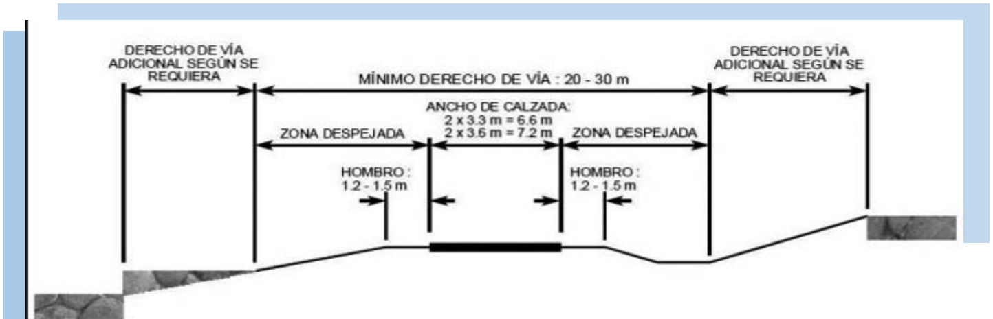
Figura 2 Derecho de vía, sección transversal de una carretera
