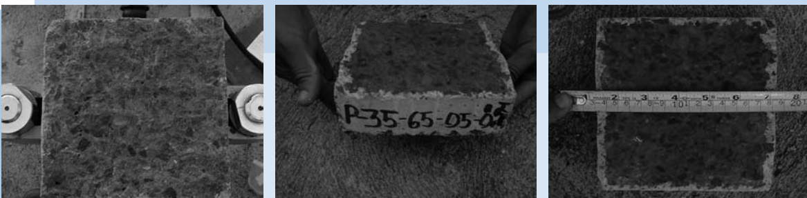
Figura 4 Determinación del avance de carbonatación en bloques de concreto. [Proyecto DURACON]
