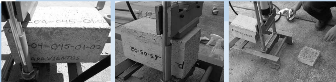
Figura 3 Corte del bloque de concreto para determinar el avance de carbonatación. [Proyecto DURACON]
