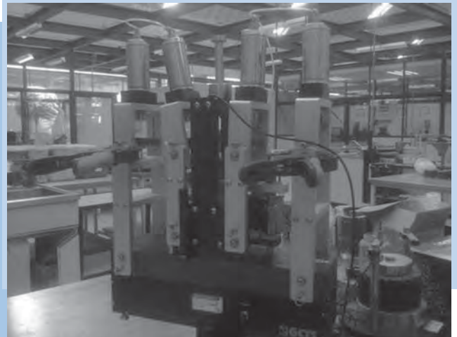
Figura 1 Comportamiento a la fatiga de mezclas asfálticas y equipo utilizado para ensaye de fatiga (viga en cuatro puntos)
