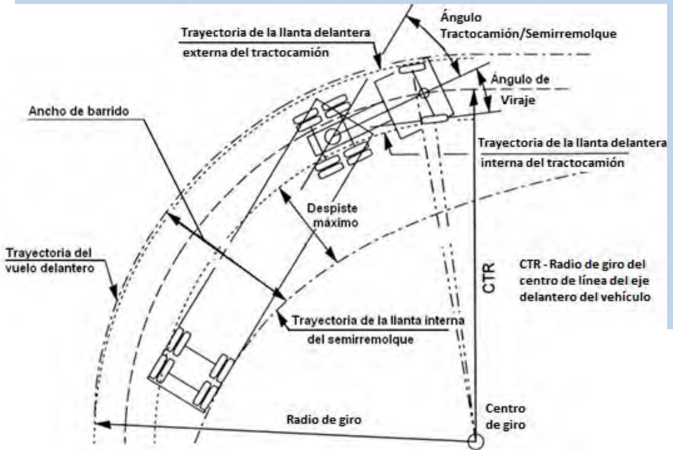
Figura 1 Ampliación de un tractocamión articulado. Trayectorias, radio de giro, despiste máximo y ancho de barrido
