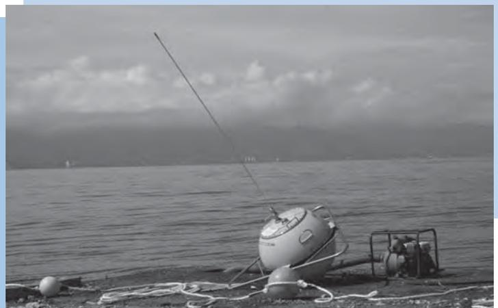
**Boya direccional medidora de oleaje**
